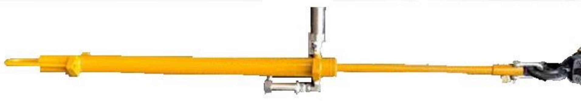
Figura 1. Pistón hidráulico activado mediante el oleaje, utilizado para presurizar el agua de mar.
