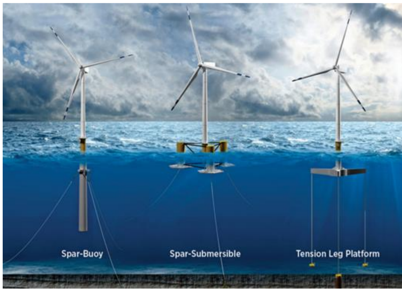
Fig. 1 Turbinas eólicas marinas flotantes
